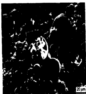
fig. 6. Obrazy SEM zaczynu z wyjściowym popiołem lotnym „Karolin” po różnych dawkach promieniowania [MGy ]: a) - 0; b) - 4,7; c) – 19,7
