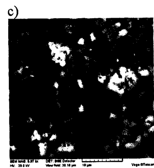
fig.5. Obrazy SEM zaczynu bez dodatku po różnych dawkach promieniowania [MGy ]: a) - 0; b) - 4,7; c) - 19,7
