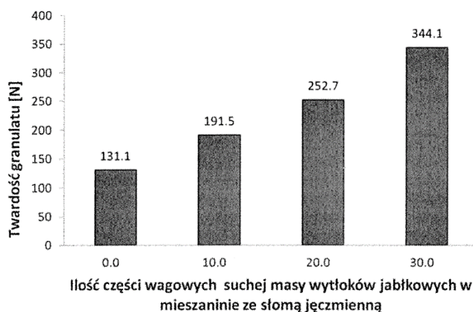
Fig. 1. Wpływ ilości części wagowych suchej masy wytlóków z owoców jabłoni w mieszaninie ze słomą pożniwną jęczmienną na twardość granulatu wykonanego z tej mieszaniny.
